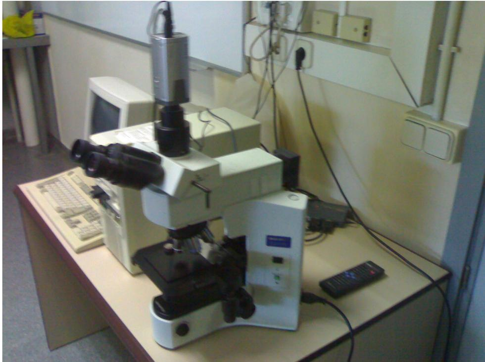
Microscopio de refracción para posibilitar la observación de materiales no translucidos, como son los metales. Esta observación se reduce a la superficie del mismo teniendo que irnos a la difracción por rayos X para saber como es la estructura interna.
