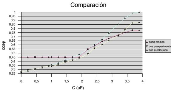
La última gráfica refleja los valores del  $\cos \phi$  medido con el fasímetro, el  $\cos \phi$  calculado con los datos de la intensidad obtenidos durante el experimento y el  $\cos \phi$  calculado.
