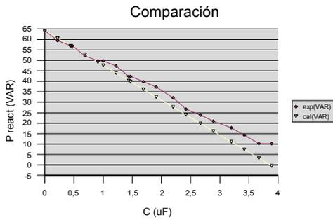
En esta gráfica se ve como la potencia reactiva calculada forma una línea recta mientras que la experimental con valores bajos de capacidad es muy similar. Pero según estos aumentan se alejan cada vez más debido a la imprecisión de los instrumentos al ir disminuyendo la intensidad que es lo que en realidad medimos para llegar a la potencia reactiva.
