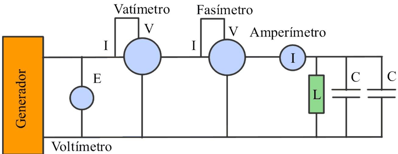
Está compuesto por un generador, que en nuestro caso usamos la red eléctrica convencional, y de 4 medidores, el voltímetro, el vatímetro, el fasímetro y el amperímetro. Así mismo tenemos nuestra instalación eléctrica nombrada por L y en serie los condensadores que vamos poniendo.
